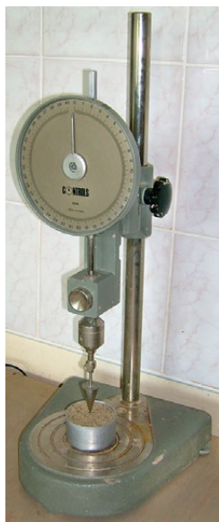
1.3 pav. Prietaisas ir braižomas grafikas takumo ribos drėgniui nustatyti
